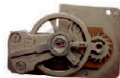
Mechanizm wychwytowy 5.1503.242 prędkościomierza Hasler Escapement assembly 5.1503.242 Hasler's speedometer
