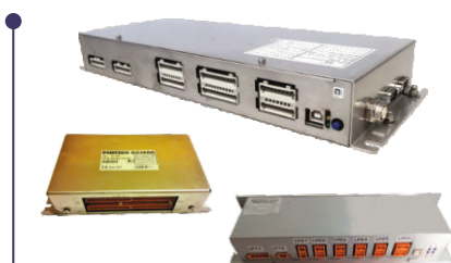
Sterowniki drzwi (w tym WC) Door controllers (including toilets)
